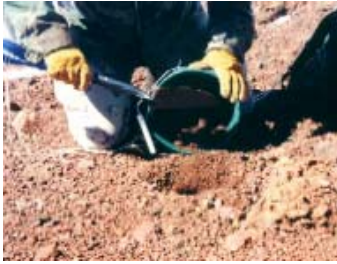
Step 1 Dig Trap Hole
